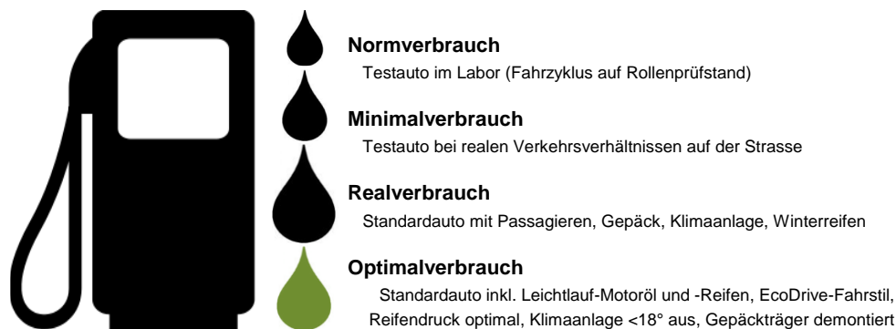
Abbildung 1 Definition von Norm-, Minimal- und Normverbrauch, und Optimalverbrauch als bestmöglicher Verbrauch eines optimierten Standardautos im Alltagsinsatz.
